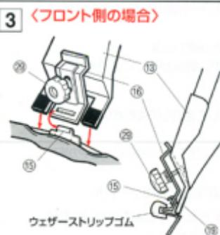
●フロント脚の㉑ 締付ノブを緩め、㉒ アウタークランプ(前)を引き出し、㉓ インナーフックに引っ掛け、㉔ 締付ノブを締め付けます。
