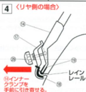
●リヤ脚の㉑ 締付ノブを緩め、㉒ アウタークランプ(後)を引き出し、レインレールに引っ掛け、㉓ インナークランプを手前に引き寄せながら㉔ 締付ノブを締め付けてください。
