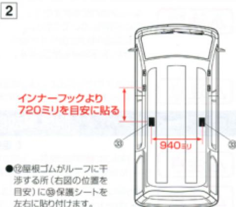
●㉔屋根ゴムがルーフに干渉する所(右図の位置を目安)に㉕保護シートを目安に左右に貼り付けます。
