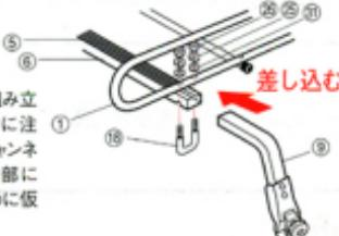
●図のように、①で組み立てた脚ステーを前後に注意して、⑤フレームチャンネルに差し込み、切込部に⑯Uボルトがはまるように仮止めしてください。
