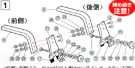
（前側） ⑨脚ステーの3つ穴の上側2つに⑪インナーカンプ（前）を⑩角根ボルトM6×12にて組み付け、⑫アウターカンプ（前）を仮組みします。（前側の図 参照）
