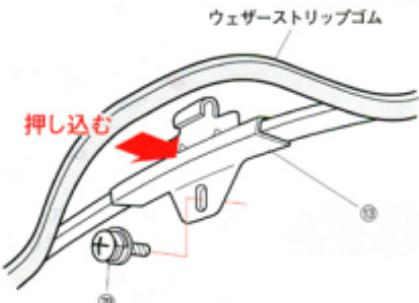
●キャビンのBのシートをはがし、⑪インナーフックを穴位置に合わせ、押し込みながら⑫丸ネジM6 P=3でしっかりと締め付け、ウェザーストリップゴムを元のよう取り付けます。
